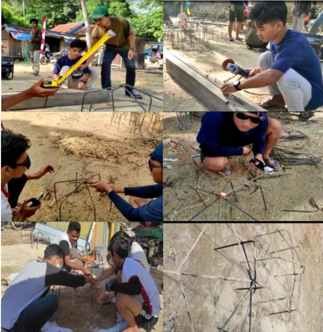
Gambar 3. Proses pembuatan media transplantasi kerangka *spider-web*
